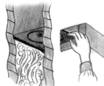
С помощью выюшки в трубе перекрывают или открывают ход для дыма.
